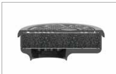
**GAZS ET VAPEURS /** Les gazs et les vapeurs sont adsorbés par des grains de charbons actifs. Ce matériau se caractérise par une structure à porosité élevée qui piège les gazs et les vapeurs dans sa surface. Elles peuvent être traitées pour adsorber sélectivement un ou plusieurs groupes de substances spécifiques.
