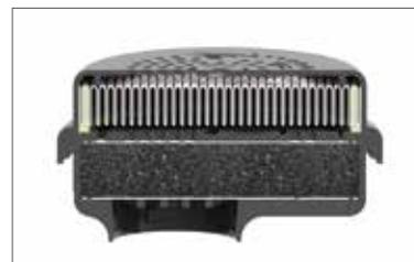
**COMBINÉ /** Les filtres combinés sont construits avec deux sections, la première avec un milieu plissé pour la filtration de particules, le second avec des charbons actifs, pour la protection des gazs et des vapeurs.
