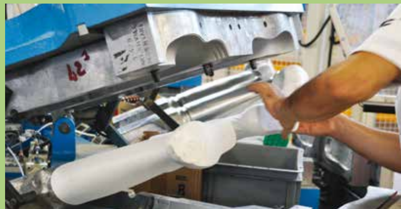
Produzione di stivali in PVC Production de bottes en PVC Producción de botas de PVC
