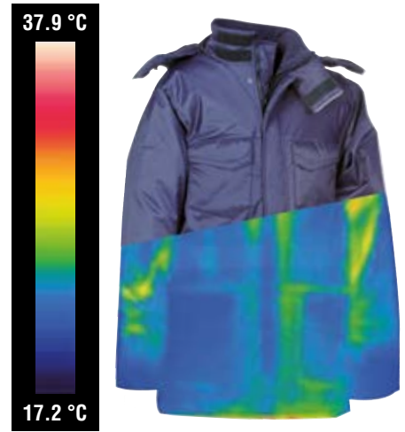
La couleur tendant vers le bleu indique le manque de fuite d'air chaude du vêtement.
